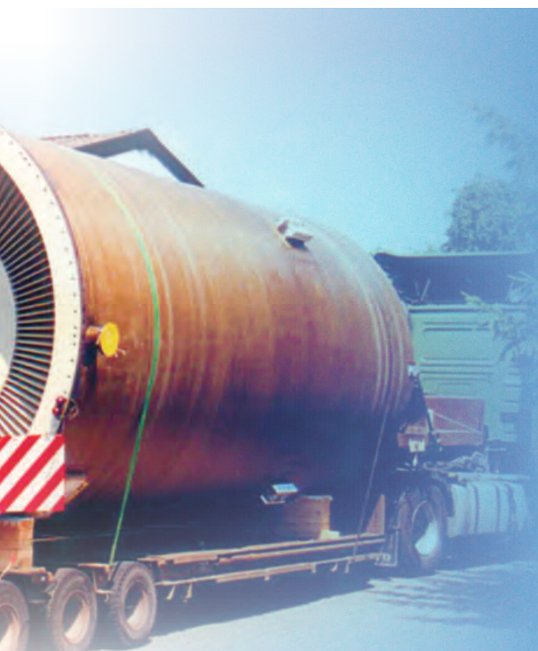
DTA chimney DN 3 000 for 290 000 m 3 /h
