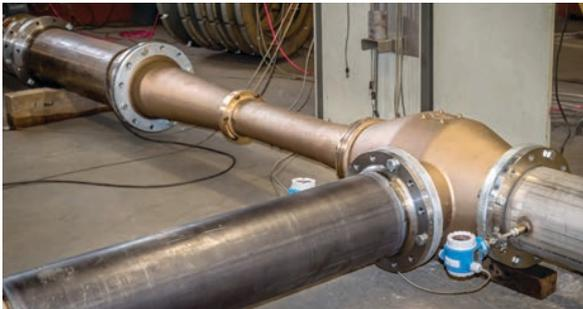
Prüf- und Versuchsstand für die GL-Zertifizierung mit 300er Nennweite
